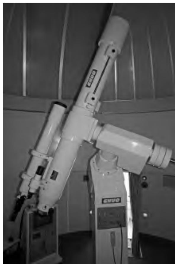
自動制御の口径20cmの屈折式望遠鏡。上に
