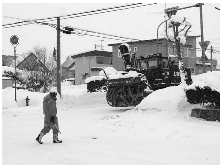
作業中の除雪ロータリー
