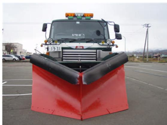
日野ダンプ（10t 級 6×6 ダンプ型、Vプラウ、アングリング路面整正装置付）
