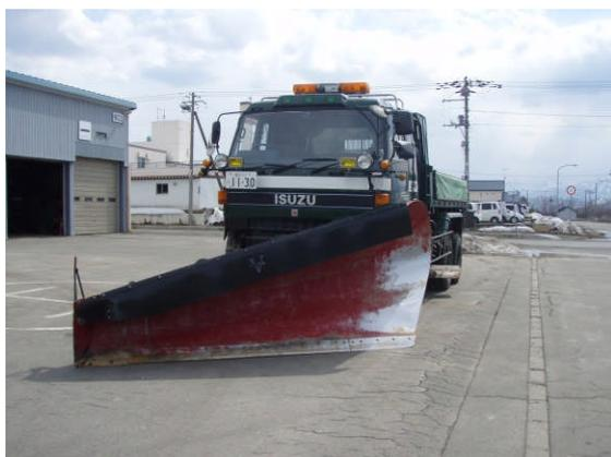
いすゞダンプ（10t 級 6×6 ダンプ型、ワンウェイプラウ、アングリング路面整正装置付）
