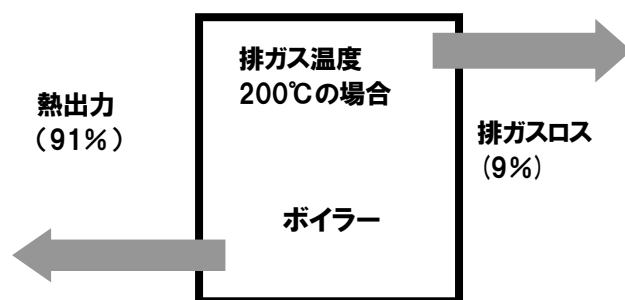
図 5-2-4 ボイラー効率の概要
