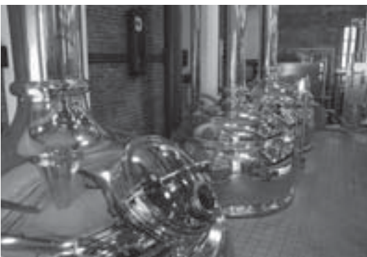
手前から仕込槽兼煮沸釜、仕込釜、ろ過槽。この3つの釜を行き来してビールが仕込まれる。奥に見えるのが沈殿槽
