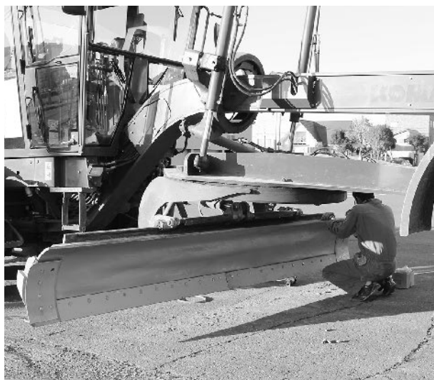
除雪前のグレーダー整備
