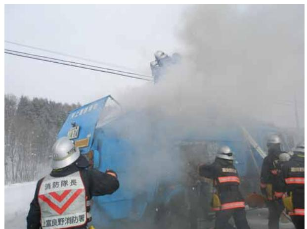
1月23日の不燃ごみの収集時に、カセットコンロのボンベが原因と思われる車両火災が発生しました。収集コースは東中市街地、旭町の一部で、不燃ごみの袋に穴を開けられていないカセットガスボンベが混入し、収集車が荷室内でごみを圧縮したときに爆発炎上したと考えられます。
